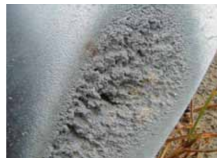
Пример кавитационной эрозии лопаток импеллера водометного двигателя
